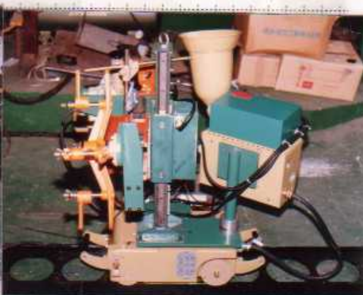
長尺ブームスライドを組込んだキロニーガイドサブマージ溶接機で、上下、左右400mmの追跡ナライが出来ます。
