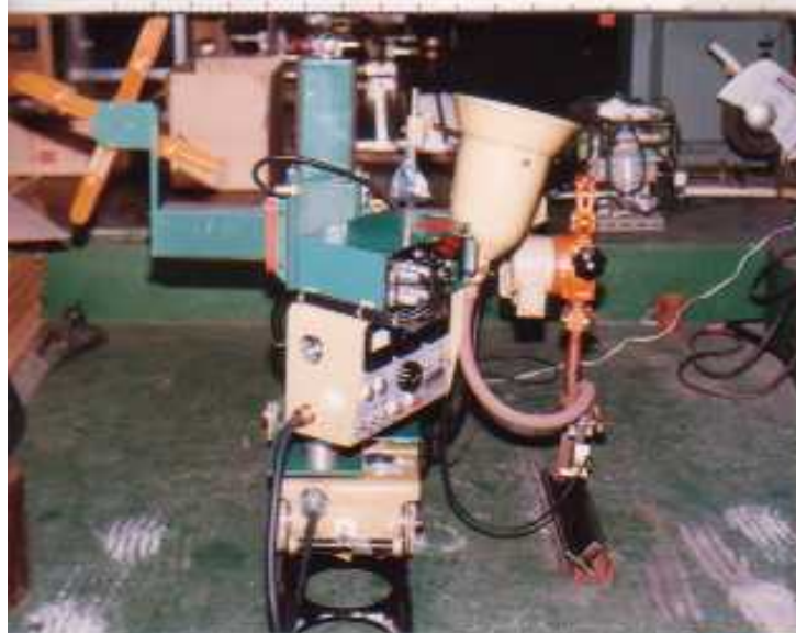
長尺ブームスライドを組込んだキロニーガイドサブマージ溶接機で、上下、左右400mmの追跡ナライが出来ます。
