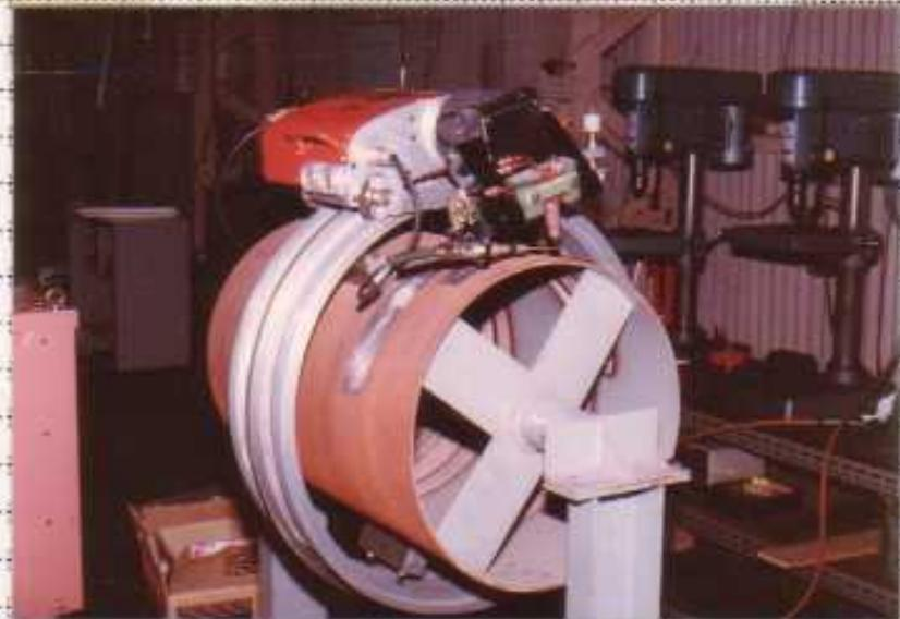
中径管から、直線までの自走式全自动5軸ロボットです。
