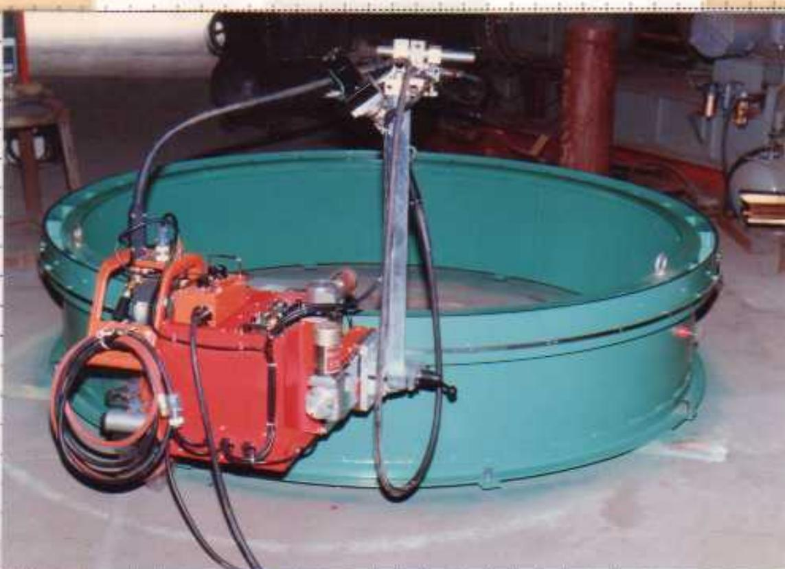
大径管の水平溶接を行うもので、円状レールを大径管の下に挿入して溶接するのですが、芯ずれが生じますので、ナライによって溶接しています。
