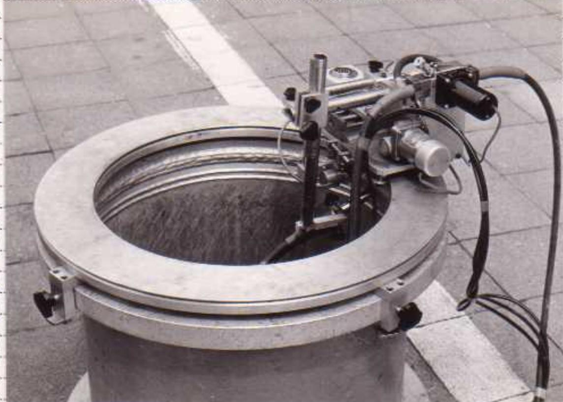
フランジの内面、溶接を行う、専用溶接機です。
