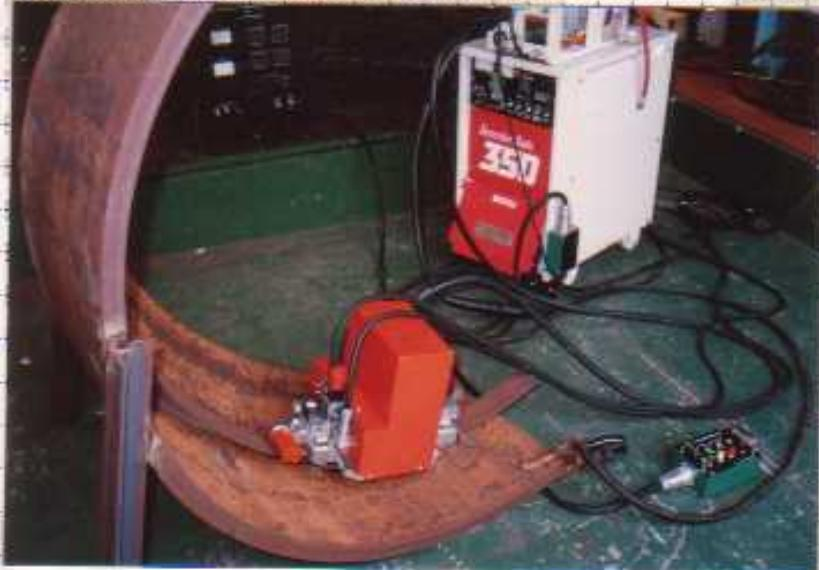
大径管の管内から円周溶接を全姿勢で溶接する装置
