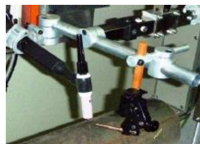
トーチ部組込例 ワイヤノズル調整機構 WS-THL 型
