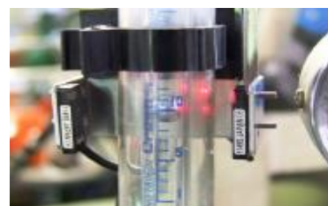
オプションセンサ例 ガスゲージ後付式ガス検知 センサ(光電式)設置事例
