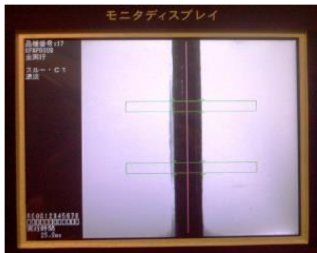
赤線=センターライン 緑色枠=位置判断有効エリア(エラー時赤枠表示)
