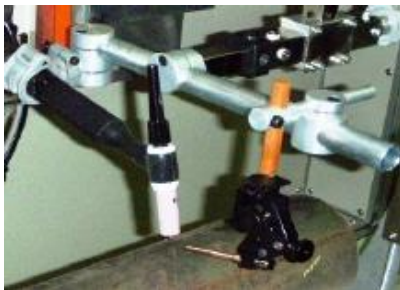
トーチ部組込例 ワイヤノズル 調整機構 WS-THL 型
