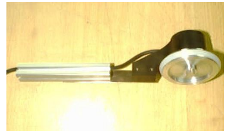
速度計測用センサ:EARC101A
