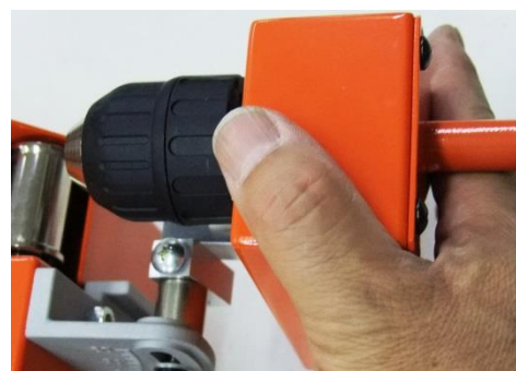
チャック後部 安全カバー 回転中の電極棒 から作業者の指 を保護します
