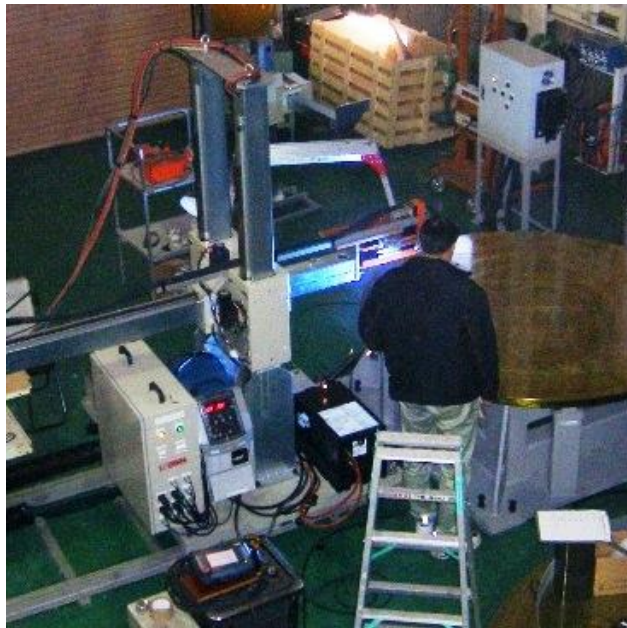
タンク溶接自走台車
