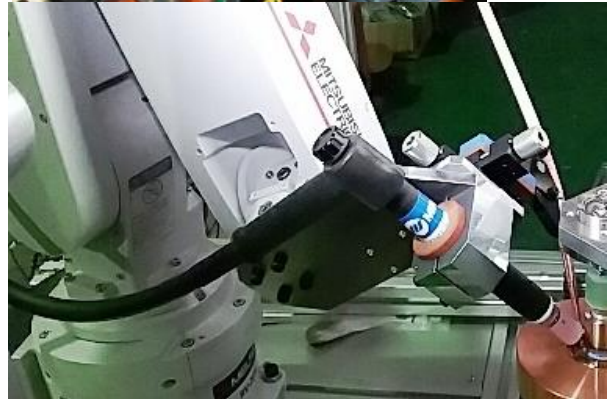
汎用ロボット トーチ部組込例 ワイヤノズル 調整機構 WT-TH 型
