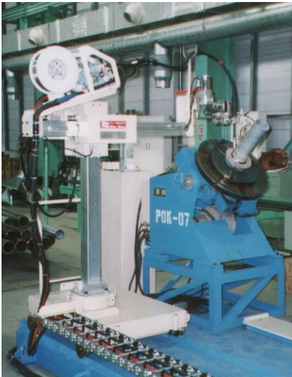
大型円筒溶接システム特殊組込例
