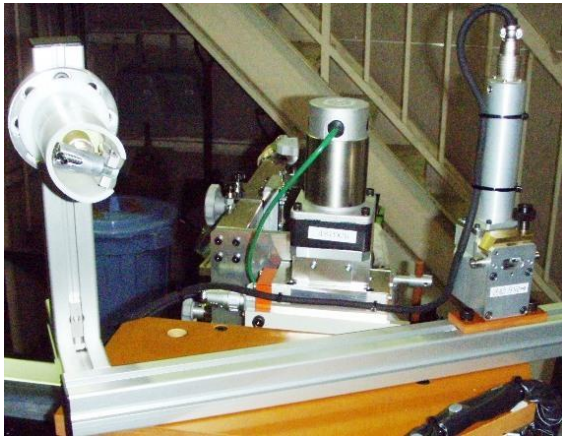
トーチ部組込例 ワイヤノズル 調整機構 WS-THL 型
