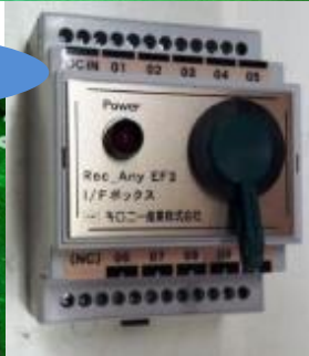
<< I/Fボックス >> 縦 90×横 70×高 60mm 電源電圧 5~15VDC スイッチ・センサ 10点まで接続・管理可能 << 電源ボックス >> 入力 AC100V 50/60HZ 出力 DC12V0.9A I/Fボックス以外に各種センサ電源として利用
