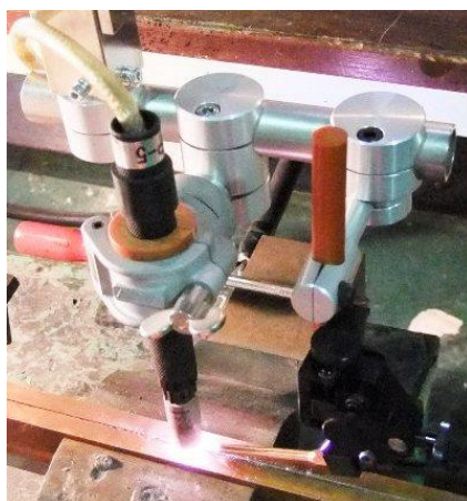
ホルダ HH32 による TIG トーチ組込事例 HSL シリーズ(φ25) パイプホルダ類により ワイヤノズル調整機構 WS-THL 型(旧型)を セッティング
