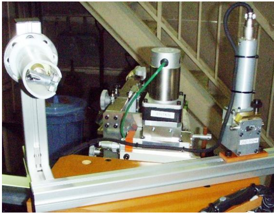
トーチ部組込例 ワイヤノズル 調整機構 WS-THL 型 (旧型)
