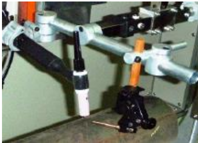
トーチ部組込例 ワイヤノズル 調整機構 WS-THL 型 (旧型)
