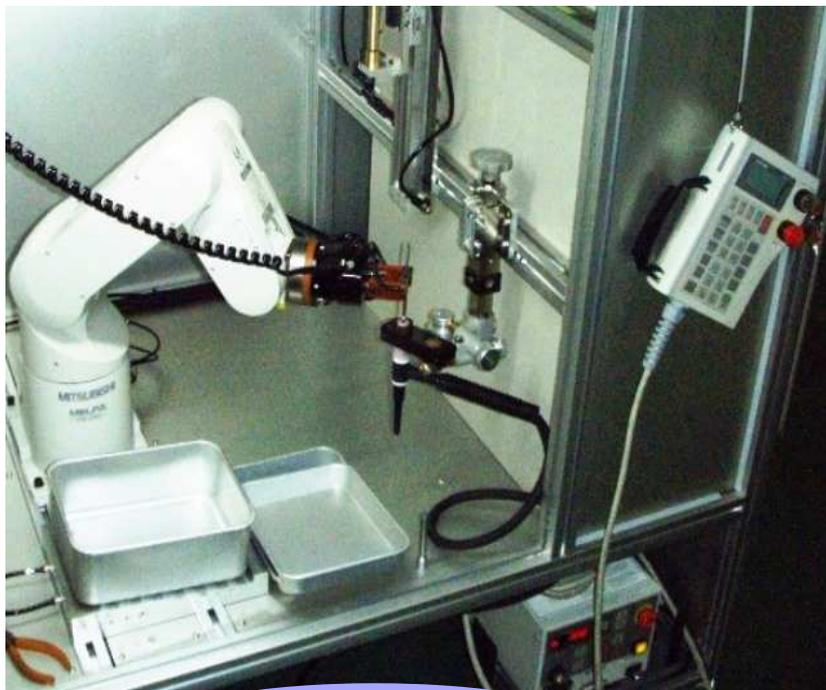
ステンレスの管に芯金を挿入し、管端をTIG溶接する溶接ロボットシステム事例です。
