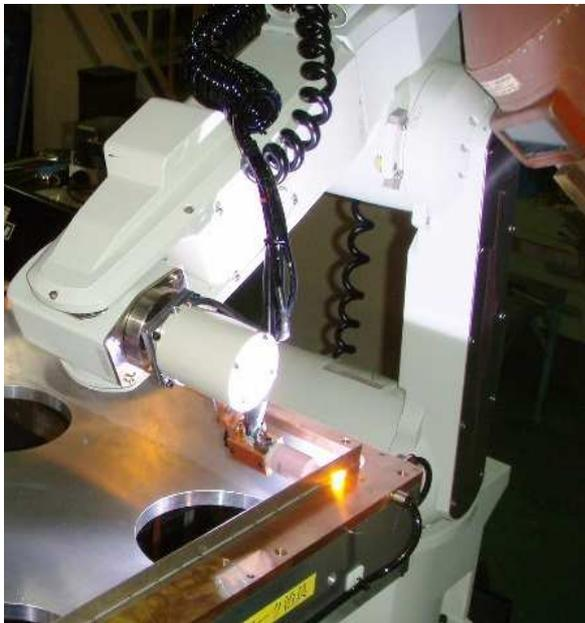
ロボットのティーチングを正確に行なっても、薄板を溶接する場合、溶接途中の変形・歪みは避けられません。治具で拘束するにも、ワーク形状に拠っては、不可能な部位もあります。
