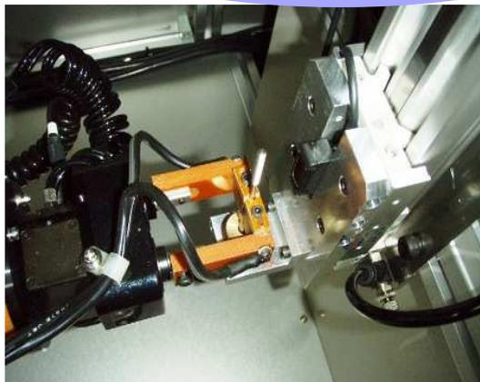
ワーク検出用ビームセンサにてパーツセッティング状態を確認し、次工程のトーチ部へ移動し、TIG溶接を設定データにて行います。
